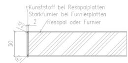
**Platte D:** 30 mm stark, aus 28 mm Mehrschichtgütespanplatte E1, Plattenoberseite wahlweise Kunststoff HPL oder Furnier nach BRUNE®-Kollektion. Plattenunterseite HPL weiß bzw. Buche Furnier. Kante Buche-Massiv-Einleimer, glatt gefräst, 9 mm stark.
